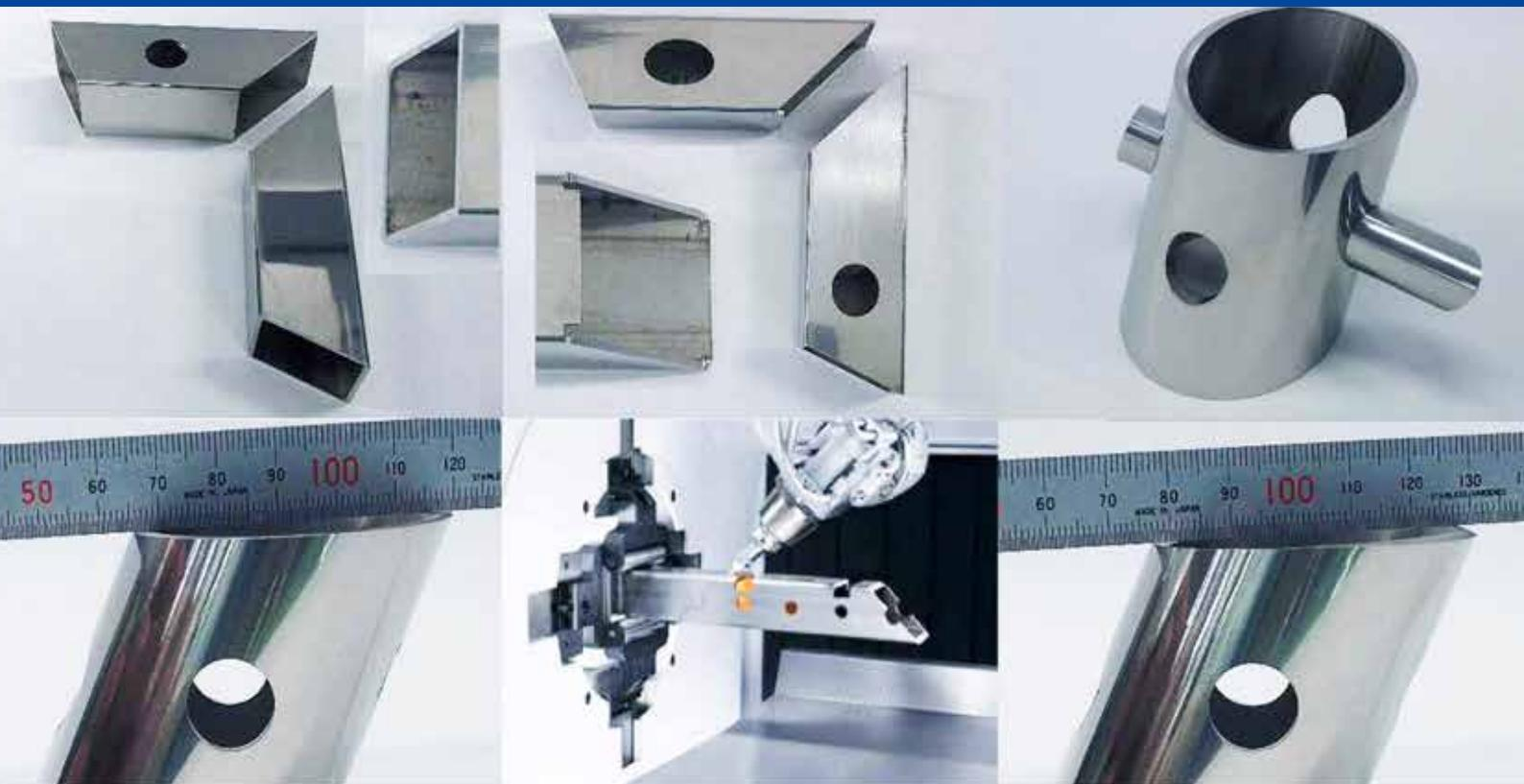
レーザー加工の基本は、板の厚さ方向は、 $90^\circ$  とないますが、角パイプ、丸パイプについては、3Dヘッドで最大 $45^\circ$  (SS)までノズルを傾けて加工できます。今まで設計段階で加工不可能だった複雑形状も高精度で加工可能となり、新たな時代の幕開けとなります。
